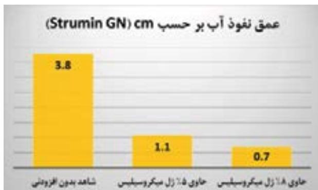
یا ملات سیمانی بین ۴ الی ۱۰ درصد وزن مواد سیمانی می‌باشد. میزان مصرف دقیق هر طرح بهتر است با آزمایش در آزمایشگاه یا محل پروژه تعیین گردد. جهت اطلاعات بیشتر، مصرف محصول خارج از محدوده و یا مصرف محصول درکنار سایر مواد افزودنی با بخش فنی و تحقیق و توسعه Strumix تماس بگیرید.
